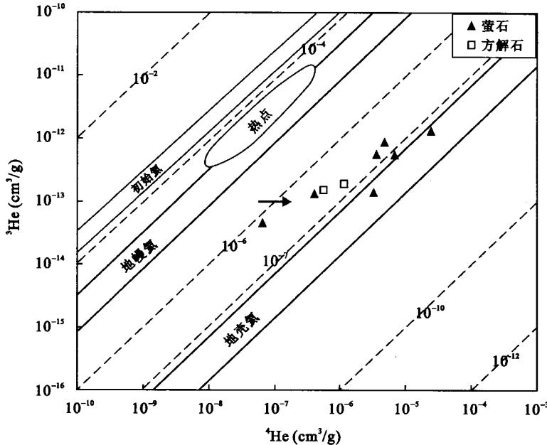
图3 302铀矿床He同位素组成演化图(底图据 Mamyrin et al.<sup>[52]</sup>)
