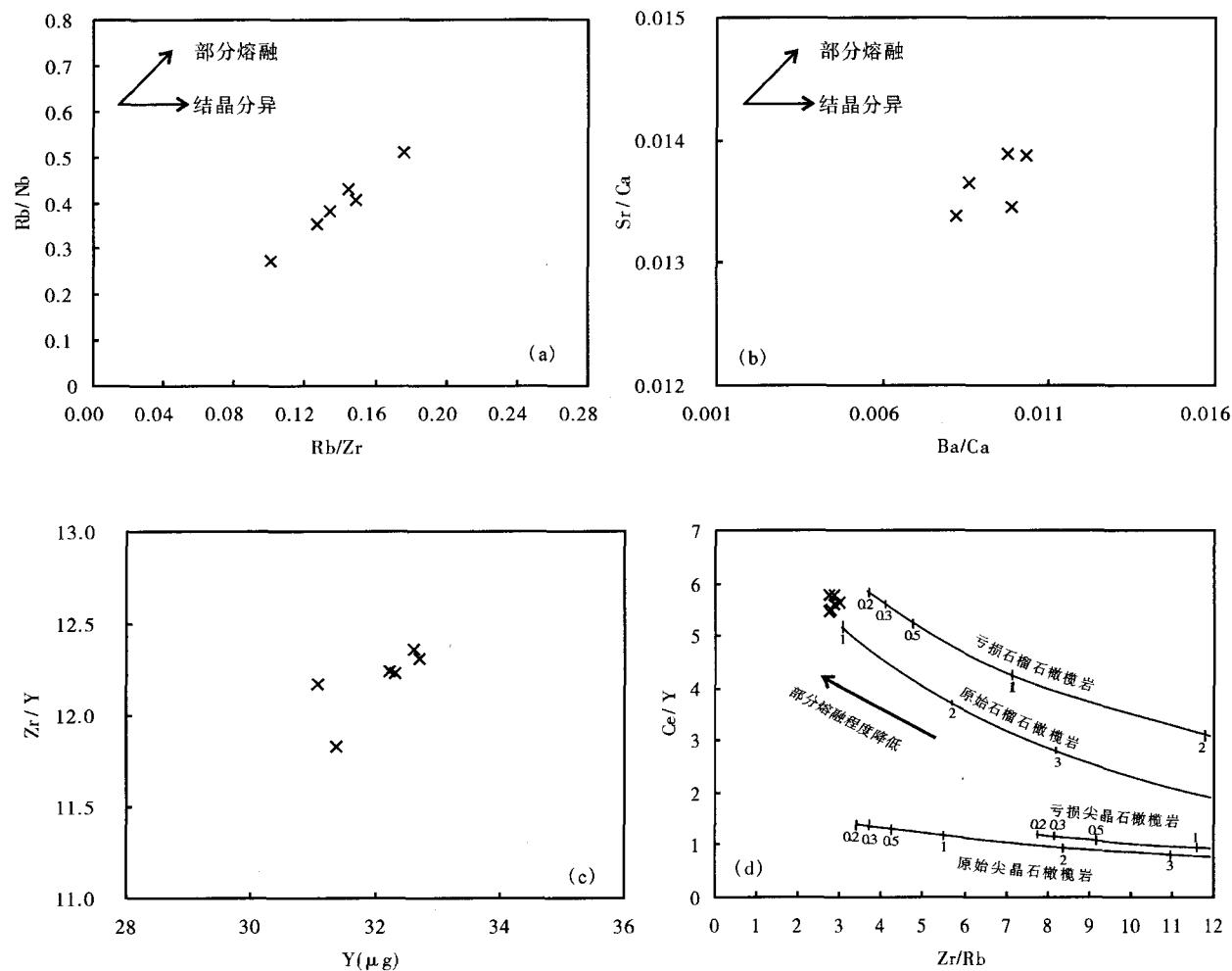
图 6 柳城玻基辉橄岩部分熔融判别(a、b)与地幔岩相判别图(c、d)
