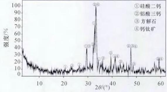
图1 烧结法赤泥的X射线衍射图谱
