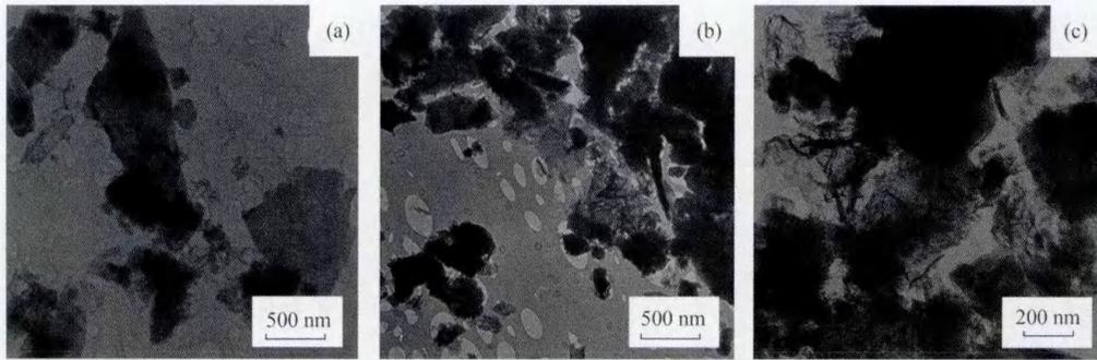
图2 透射电镜下的烧结法赤泥
