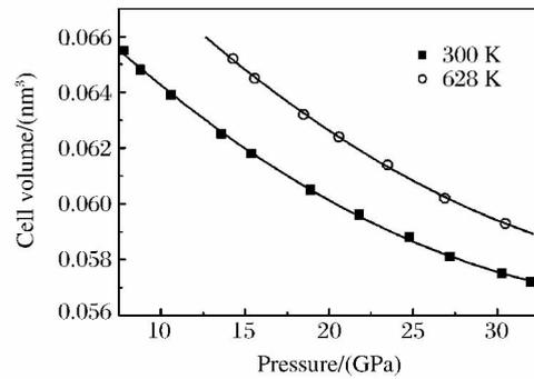
图 2 黄铜矿 Rocksalt 相室温和 628 K 时的  $p-V/V_0$  图
