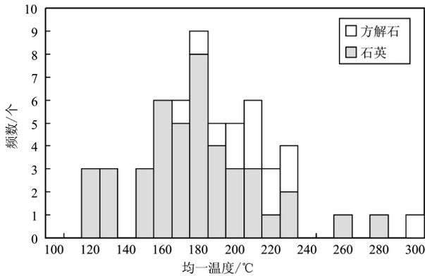
图 7 合仁坪金矿床流体包裹体均一温度直方图
