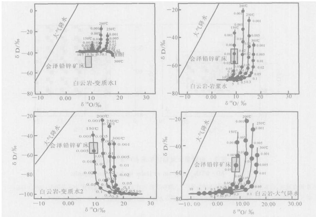
图3 会泽铅锌矿床的水-岩反应图解
