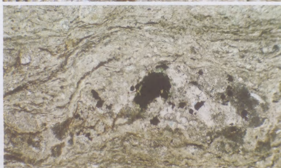
3. GZ 04 -21-4, 平秋金矿, 变余砂岩。实验后产生褶曲, 含金硫化物(黑色)和石英(白色)沿褶曲核部充填。实验温度 500°C, 轴压 1450MPa, 围压 360MPa, 时间 12h。×30(-)
