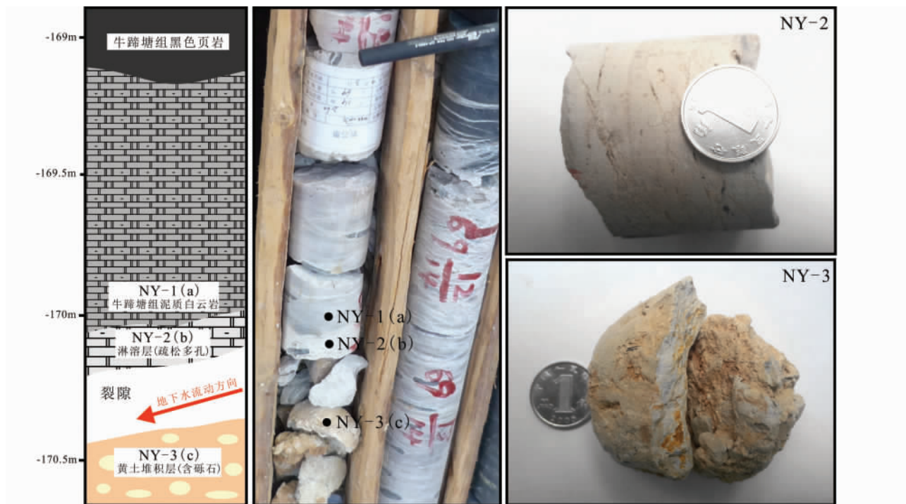
图3 纳雍地区泥质白云岩“掉井”样品风化剖面及采样位置图
