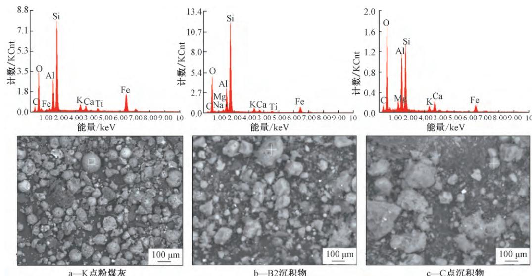
图6 K点粉煤灰、B2点沉积物及C点沉积物SEM-DEX图像
