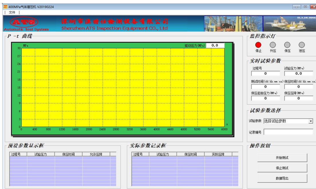
图 2.9 400 MPa 超高压气体增压装置自动控制软件界面
