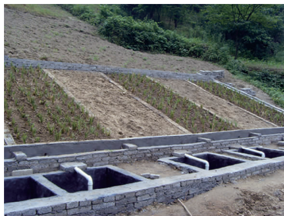
图 1 野外地表径流小区
