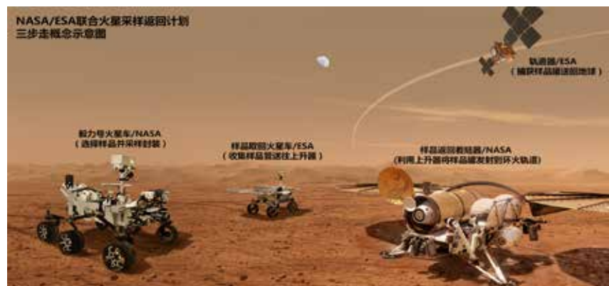
图1 NASA/ESA联合火星采样返回“三步走”概念图。整个采样计划由两辆火星车,一个着陆器和一个轨道器组成(NASA/ESA/JPL-Caltech)
