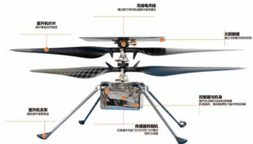
图3 毅力号携带的机智号直升机示意图(NASA/JPL)
