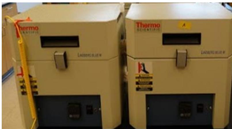
图 2.2 汞热解富集常用的两台马弗炉联用装置
