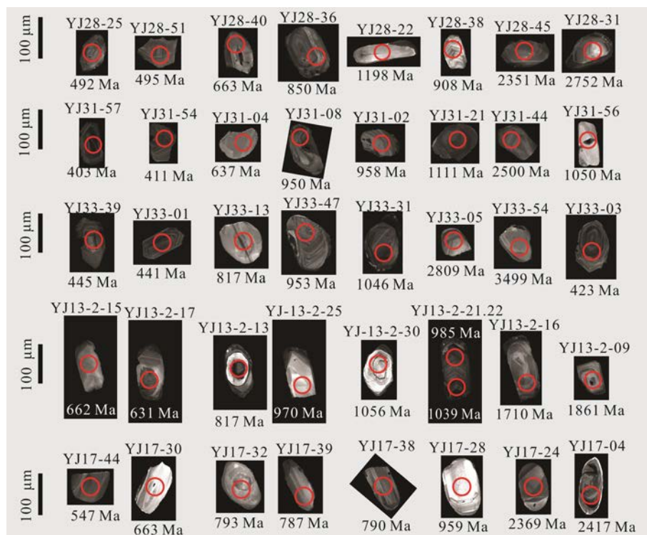
图 4 部分碎屑锆石 CL 照片(圆圈和数字代表分析位置和 U-Pb 年龄; 束斑直径为 40 \mu\text{m} )
