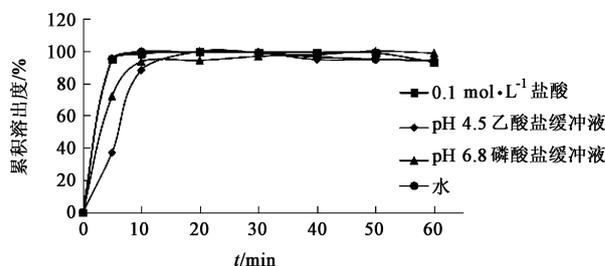
图 5 蜘蛛香总缬草三酯自微乳在不同溶出介质中的溶出曲线
