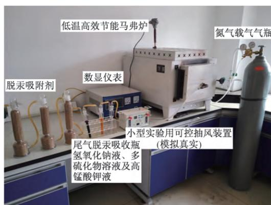
图1 低温热解脱汞处理实验装置及尾气脱汞系统
